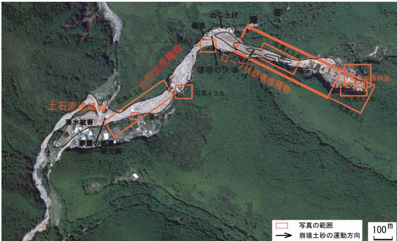
写真4.3.1 深谷の崩壊と崩壊土砂
