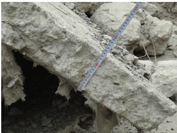
写真 5.7.5 コンクリート版の散乱(厚さ 15cm)
