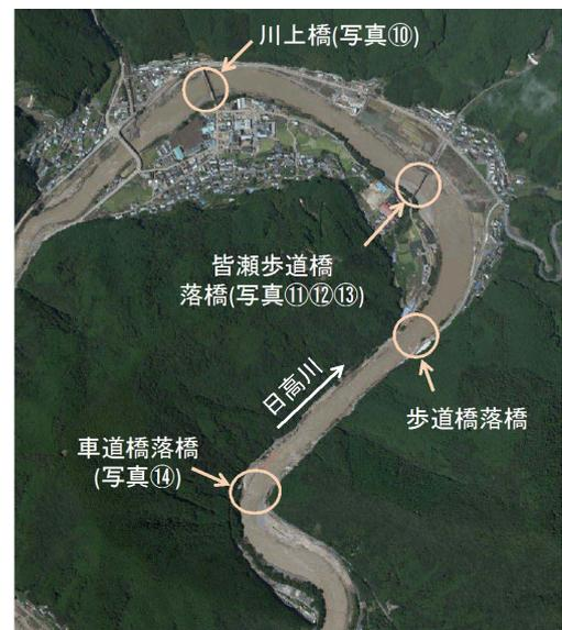
写真3.1.11 日高川町川原河、皆瀬地内の被害箇所 ③に加筆
