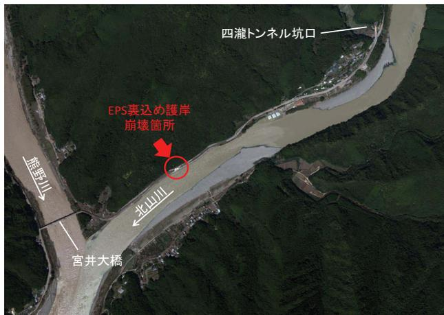
図 5.7.1 EPS 裏込め護岸崩壊箇所。
