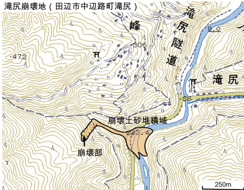
図4.2.1 崩壊地の概要 (国土地理院25000分の1地形図地図画像に加筆)
