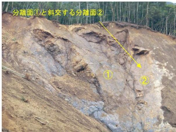
写真 4.9.2 側方滑落崖をなす分離面
