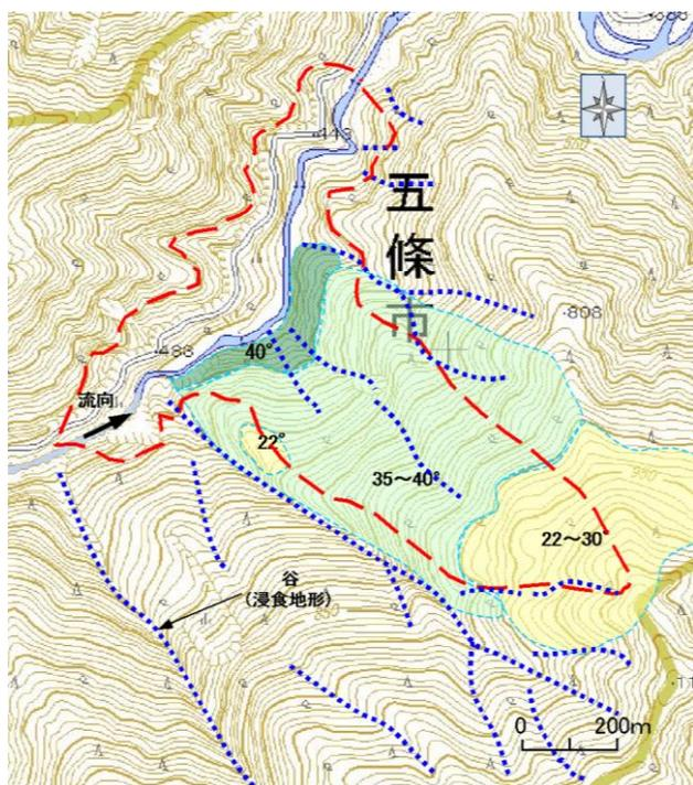
図 4.9.4 傾斜区分 (崩壊前)
