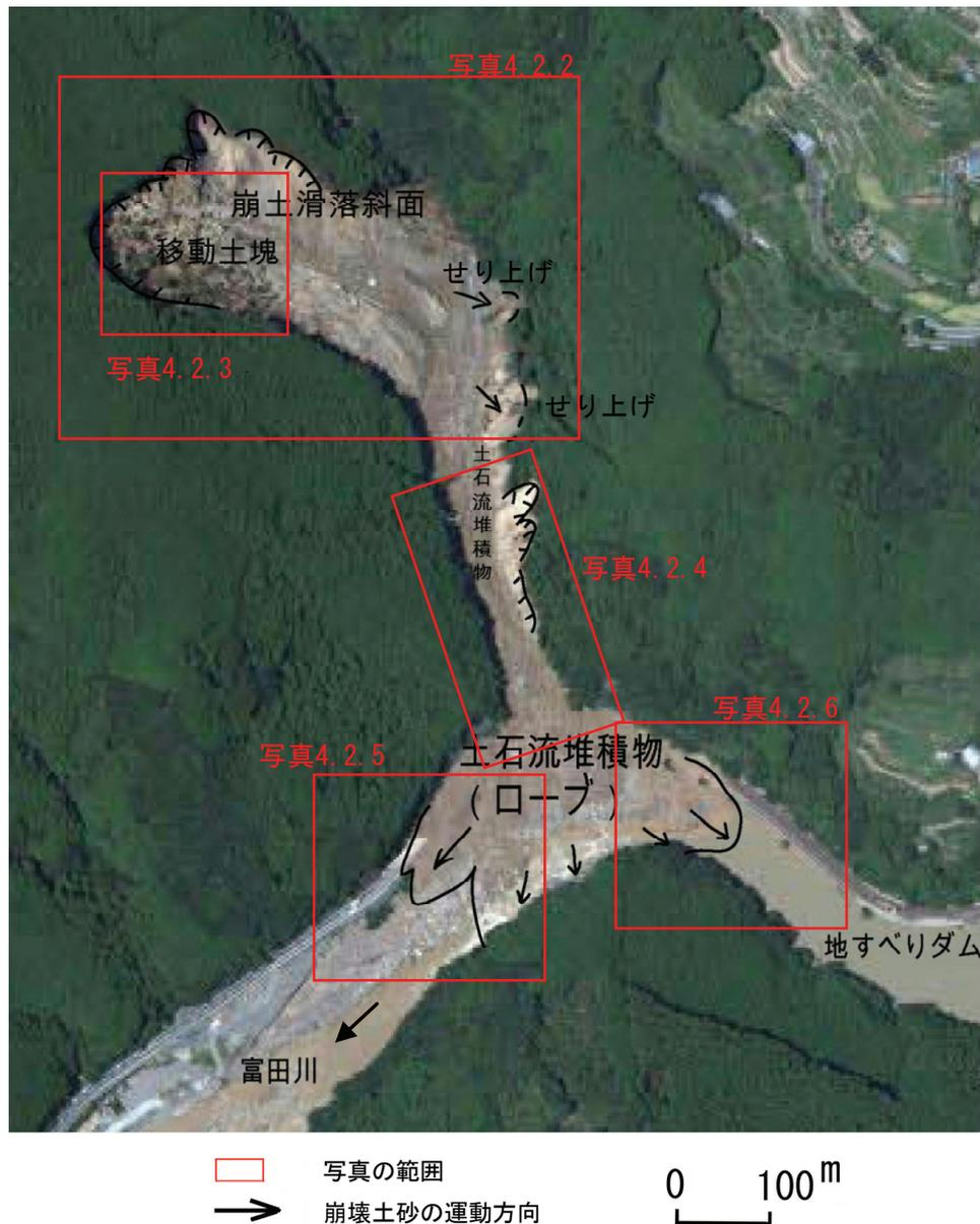
写真4.2.1 中辺路町真砂(滝尻地区)の崩壊
