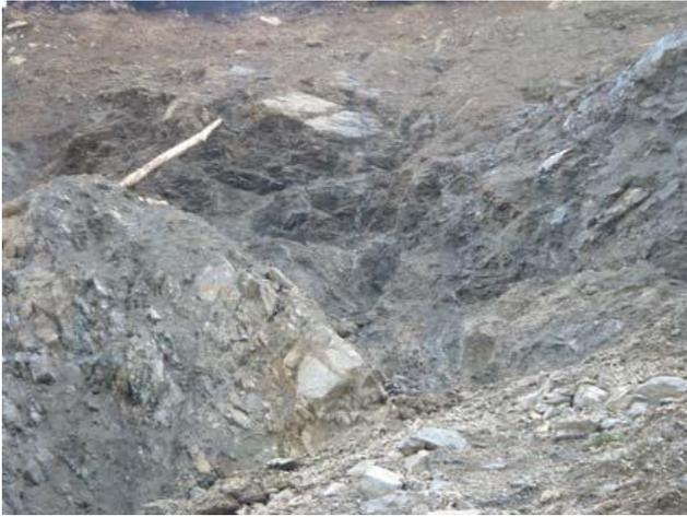
写真4. 15. 8 崩壊崖面に見られる岩盤の緩み
