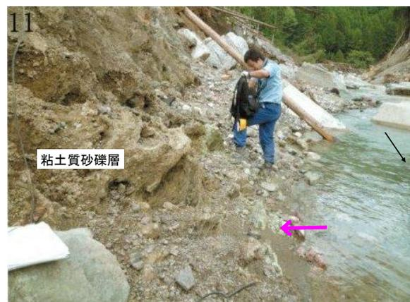
写真 4.3.8 河床に見られる粘土基質の角礫
