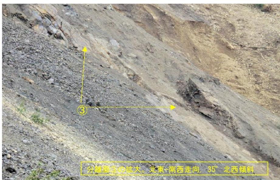
写真 4.9.5 すべり面底面を形成する分離面
