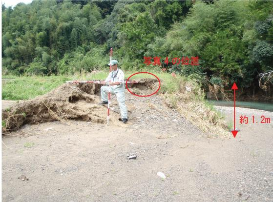
写真3.2.4 川面側堤体断面
