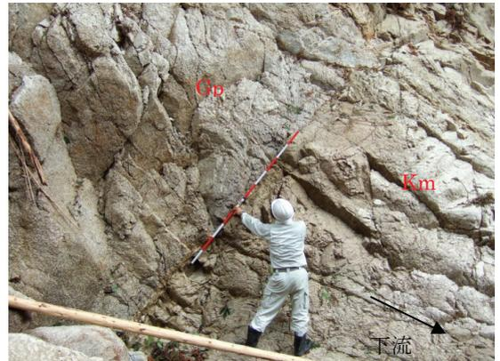
写真6.5.9 支沢b(左岸側)の熊野酸性火成岩類(花崗斑岩)Gpと熊野層群Kmとの境と思われる面(傾斜60°)
