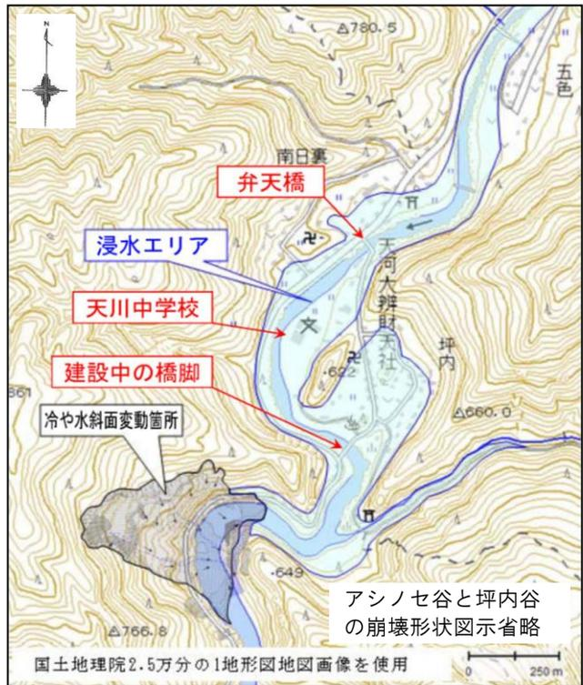
図4.5.1 河道の堰止めと最大浸水域
