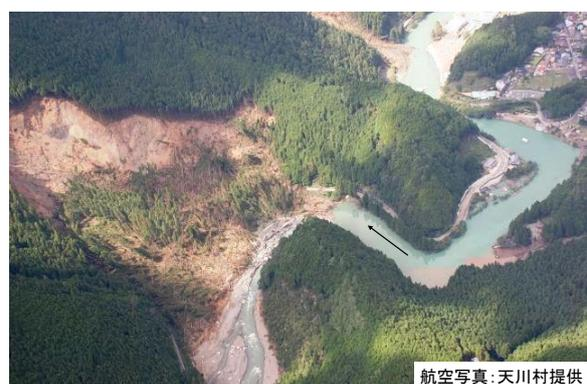
写真 4.3.9 滑動土塊による川の堰止め
