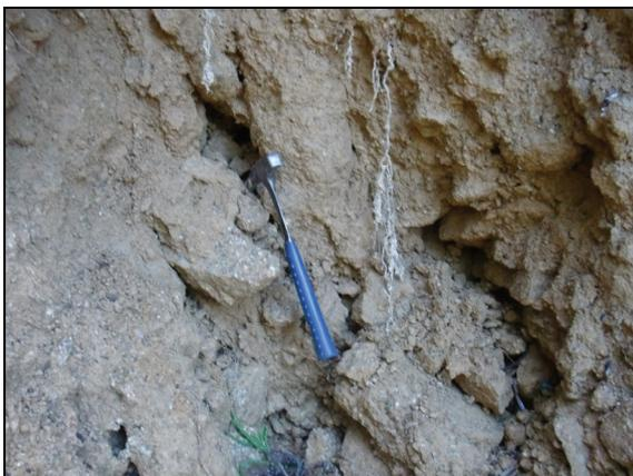
写真 5.2.3 崩壊跡①(写真 5.2.1 のポール付近、パイピング跡)
