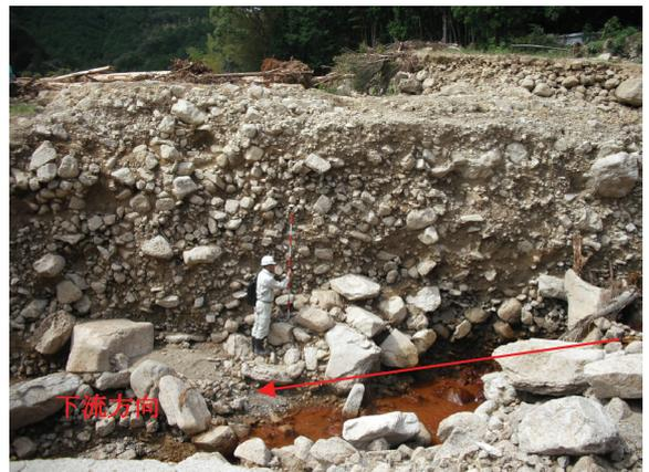
写真6.5.10 堰堤下流に見られる旧土石流堆積物(厚さ4m以上)
