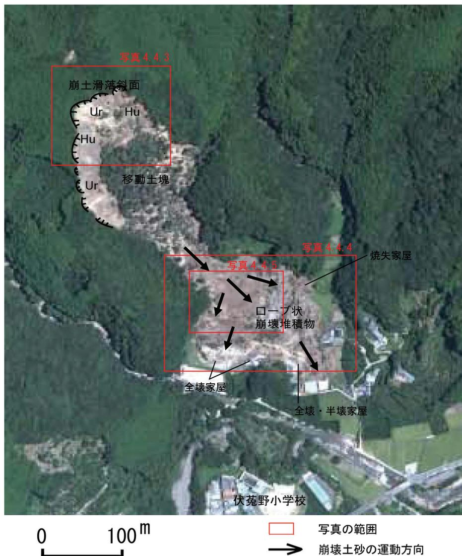
写真 4. 4. 1 伏菟野地区の大規模斜面崩壊(国土地理院「台風12号による被災に関する情報 空中写真」に加筆)。
