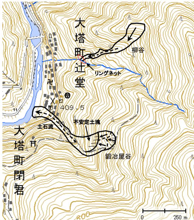
図 4.6.1 大塔町辻堂地区崩壊位置の概要
