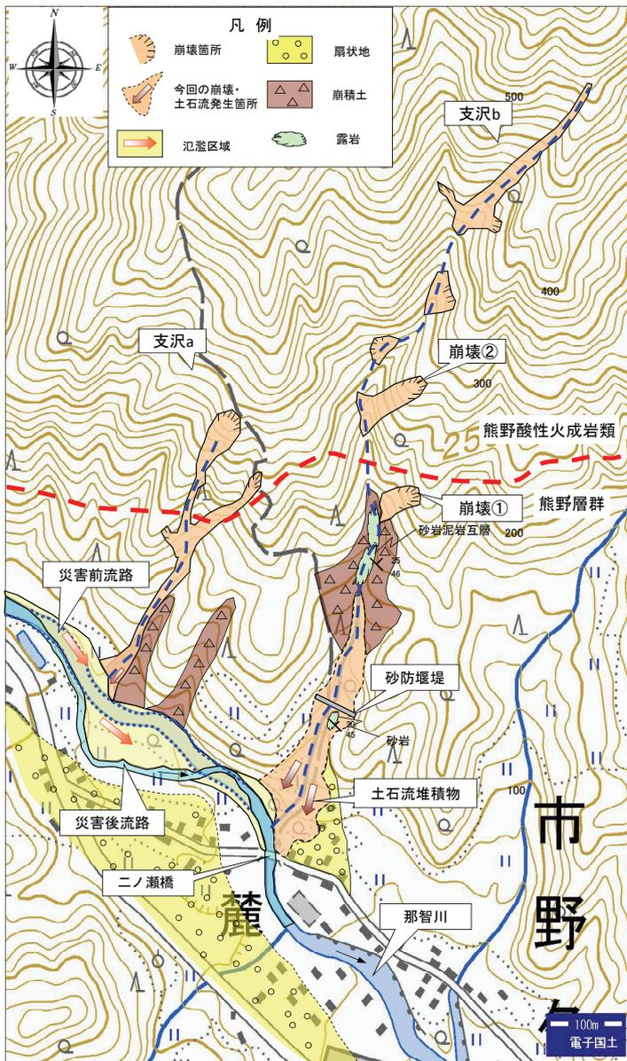
図6.5.2 二ノ瀬地区斜面崩壊・土石流箇所状況図(国土地理院基盤地図を使用)
