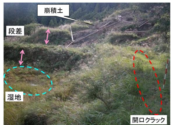
写真 4.1.9 崩壊地東斜面状況
