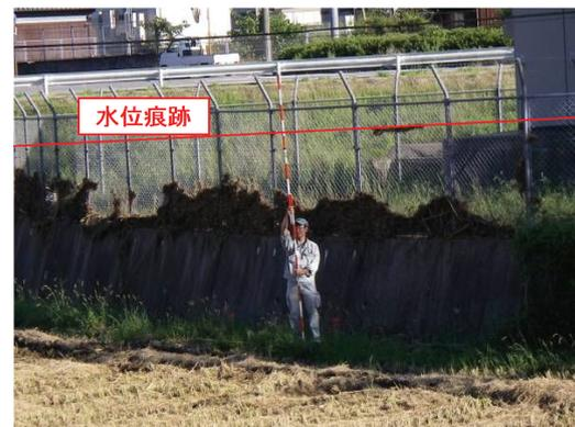
写真3.3.11 堤内地水位痕跡(写真⑤)
