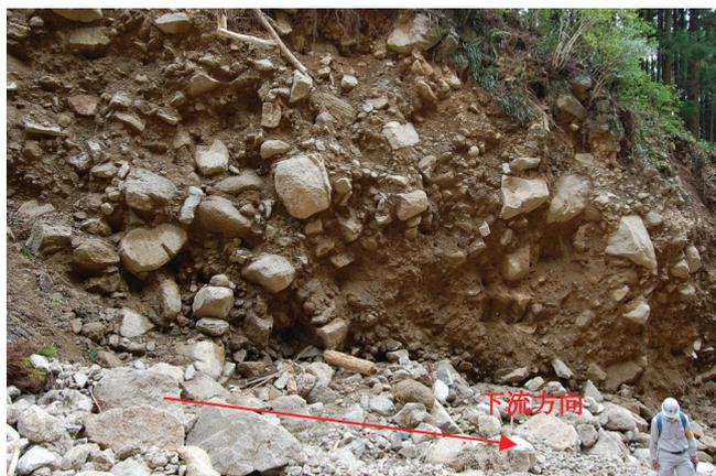
写真6.5.11 支沢bの崩壊地①付近の左岸に見られる崩積土(土石流堆積物)厚さは8m以上
