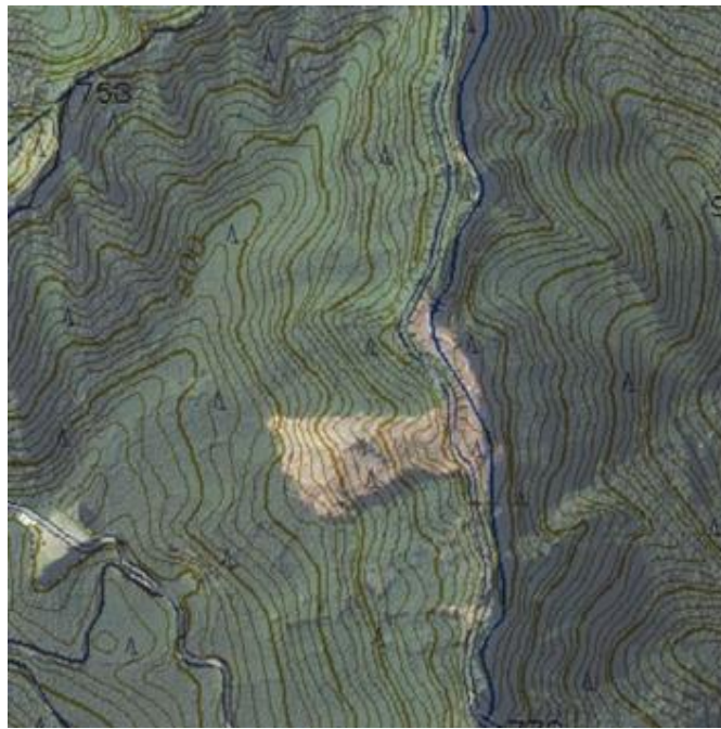
高原ダム跡南方の地滑り地の地すべり状況
