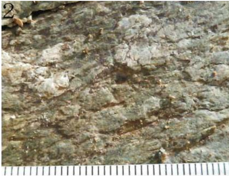
地すべり地上部の崖の南面にみられる頁岩 葉理がみられ、すべり面は葉理面を切っている
