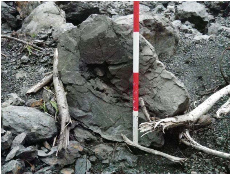
崩壊地内の転石 崩壊地内の泥質岩転石に認められる空隙・方解石の溶出跡と考えられる。
