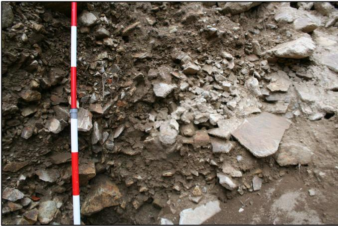
図 3.57 崩壊斜面中の空隙状況
