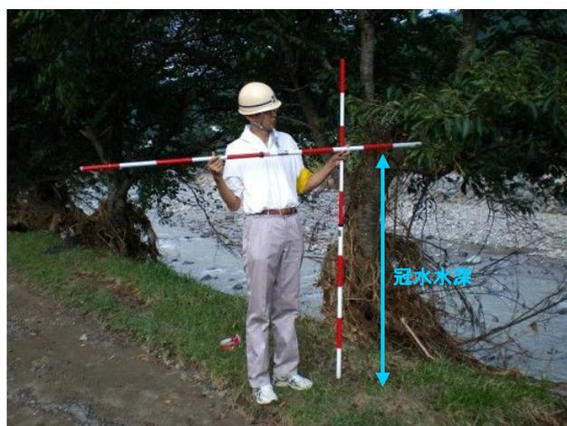
図 2.61 被災区間直上流での浸水痕跡（約 1.5m）
