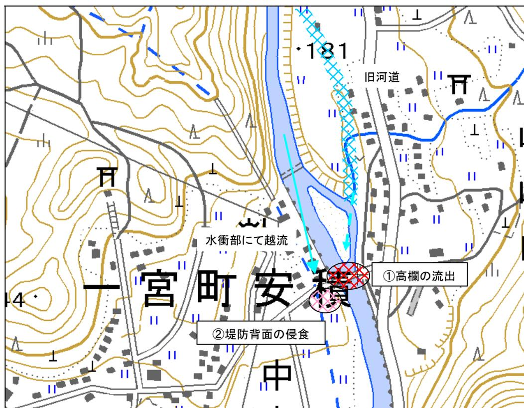
図 3.32 被災箇所概略平面図<sup>2)</sup>
