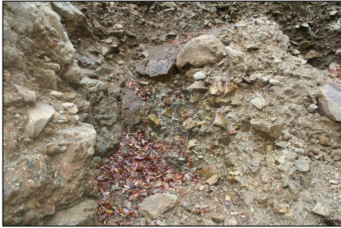
図 3.56 崩壊斜面中に見られる湧水状況
