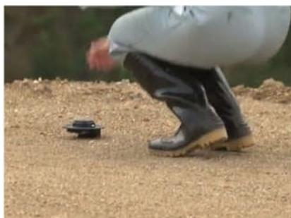
① 地上に「RWP」という2周波 RTK センチメートル級 GNSS 受信機を設置
