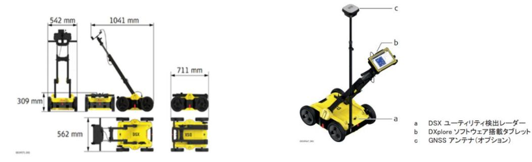
地下埋設物探査装置 DSX
