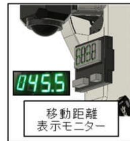
図-2 移動距離計測
