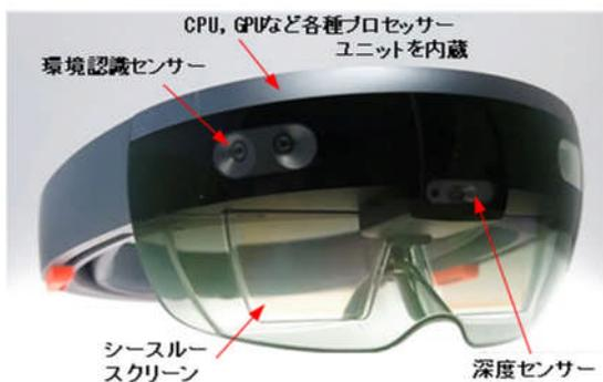
図 1 ウェアラブル端末 (Microsoft 社製 HoloLens)
