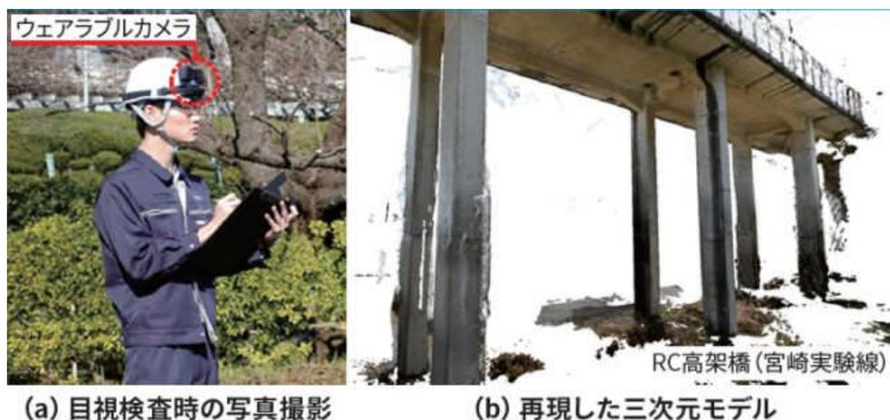
図 2 目視検査時の写真撮影と再現した三次元モデル
