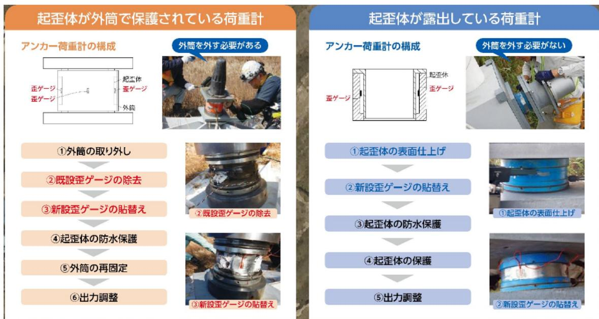
図-1 歪ゲージ式アンカー荷重計の補修再生方法
