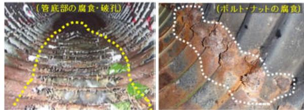
図-6 山地部盛土内 CP の管部材腐食状況
